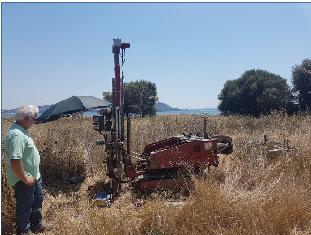
Figura 2: Prova penetrometrica CPT 2
