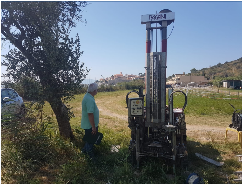
Figura 1: Prova penetrometrica CPT 1
